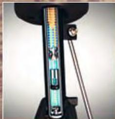
*Sulle compressioni e le estensioni leggere, molla e ammortizzatore controllano insieme i movimenti verticali senza sollecitare eccessivamente gli smorzatori idraulici, cancellando le asperità della strada e generando un effetto « tappeto volante ».*
