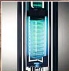
*Sulle compressioni e le estensioni più importanti, molla e ammortizzatore lavorano insieme agli smorzatori idraulici rallentando i movimenti in modo progressivo per eliminare i bruschi arresti di fine corsa e il fenomeno del « rebound ».*
