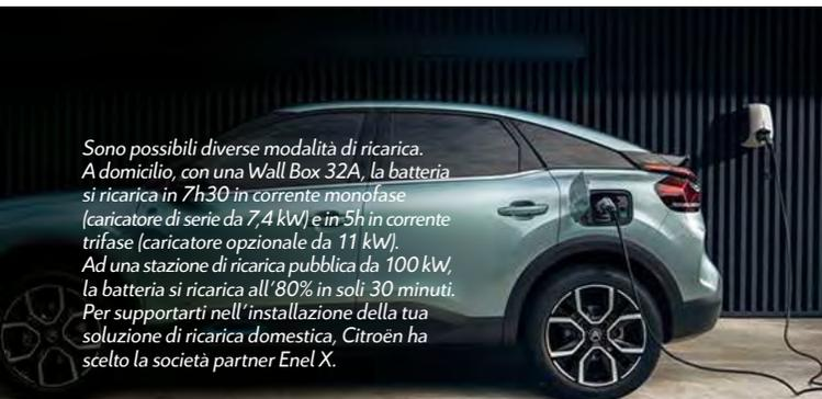
Sono possibili diverse modalità di ricarica. A domicilio, con una Wall Box 32A, la batteria si ricarica in 7h30 in corrente monofase (caricatore di serie da 7,4 kW) e in 5h in corrente trifase (caricatore opzionale da 11 kW). Ad una stazione di ricarica pubblica da 100 kW, la batteria si ricarica all'80% in soli 30 minuti. Per supportarti nell'installazione della tua soluzione di ricarica domestica, Citroën ha scelto la società partner Enel X.
